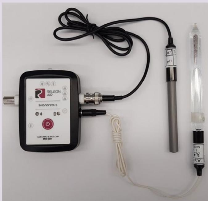
**Рис. 10.** Ионоселективный датчик
