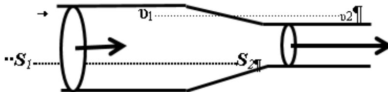
$$V_1 = V_2; \dots V_1 = v_1 \cdot S_1 \cdot t; \dots V_2 = v_2 \cdot S_2 \cdot t; \dots \rightarrow \dots v_1 \cdot S_1 = v_2 \cdot S_2; \dots v_2 = v_1 \cdot S_1 / S_2$$
