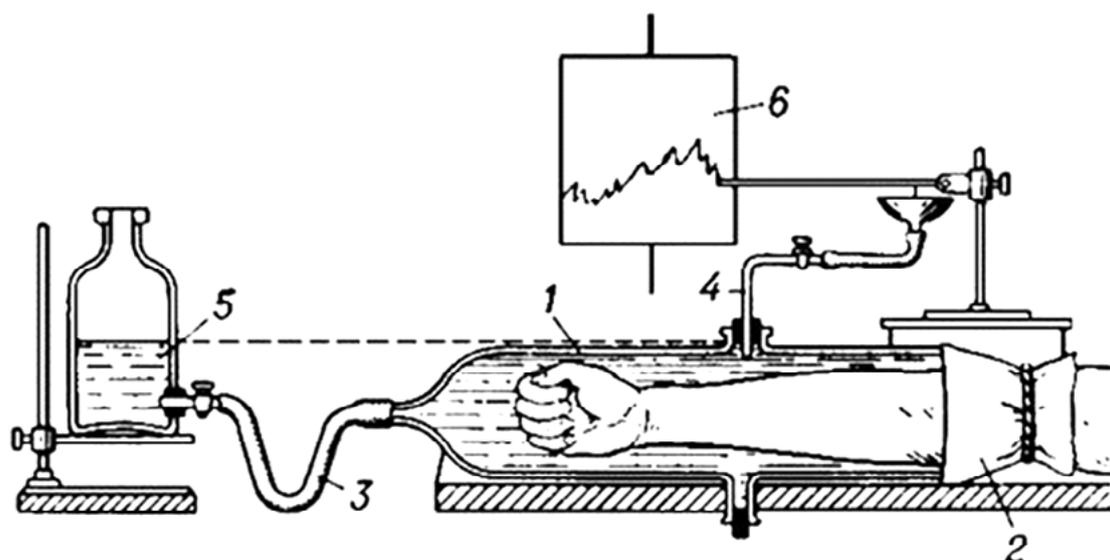
**Рис.22.** Плетизмограф — аппарат для графического определения колебаний объёма различных членов тела в зависимости главным образом от степени их кровенаполнения: 1 — цилиндр; 2 — резиновая манжетка; 3 — трубка для соединения бутылки с прибором; 4 — трубка для соединения прибора с капсулой Маррея; 5 — бутылка для воды; 6 — барабан кимографа.
